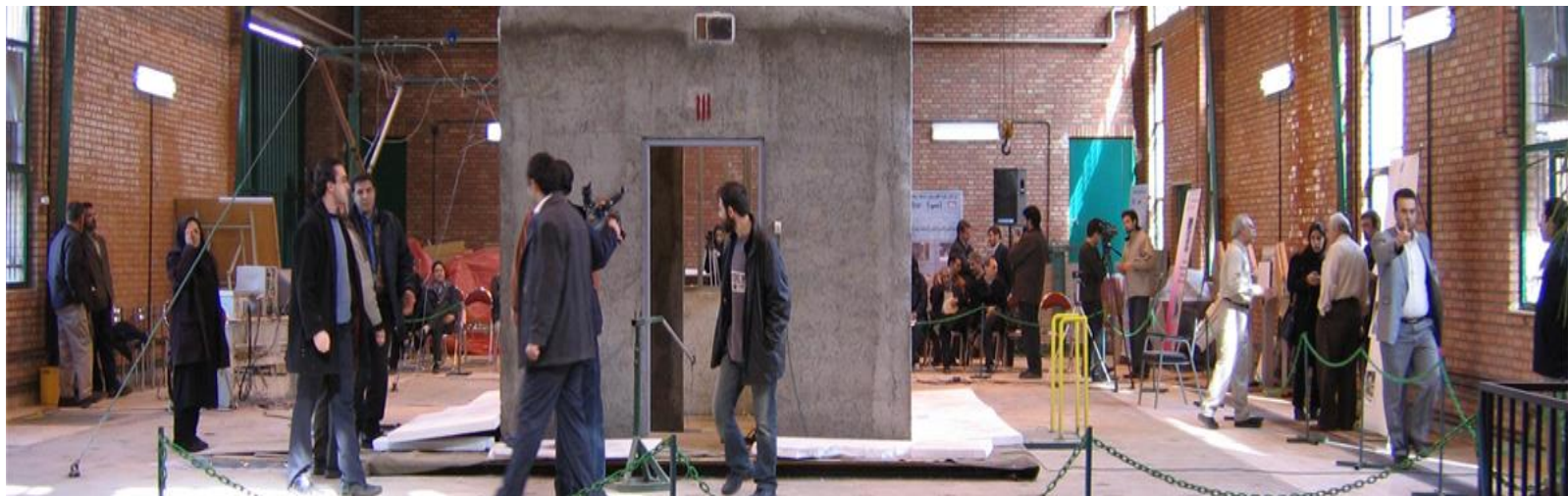
نمونه آزمایش ساختمان با مقیاس واقعی روی میزلرزان
